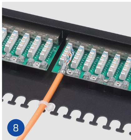
При помощи кабельной стяжки фиксируем кабель к кабельному органайзеру.
