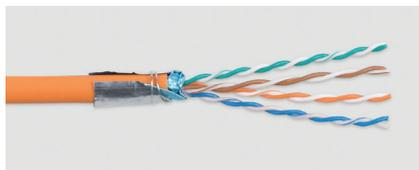
**F/UTP:** заворачиваем фольгу на оболочку кабеля, сверху наматываем дренажный проводник. Подрезаем фольгу, оставляя 2 см.
